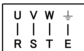
図5. モータ結線図
