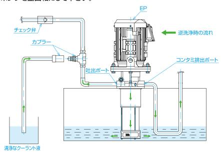
↑ 注意 逆洗浄はろ過性能を完全に回復させるものではありません。 何度もフィルターが目詰まりする場合、ポンプ仕様外で動作 している可能性があります。特に浮上油と気泡が混じらない ように注意して下さい。
